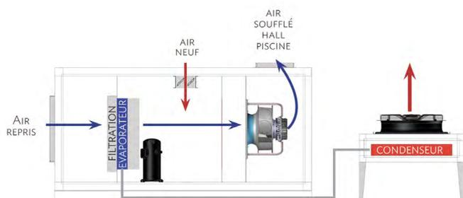
Lorsque la piscine est occupée, l'air extrait du hall, passe d'abord par l'évaporateur, où il subit une déshumidification et un refroidissement grâce à un cycle thermodynamique. L'air neuf hygiénique (si l'option air neuf est prise), se mélange à l'air refroidi. Les calories du cycle thermodynamique sont évacuées à l'extérieur par un condenseur auxiliaire, soit placé dehors, soit en local technique.
