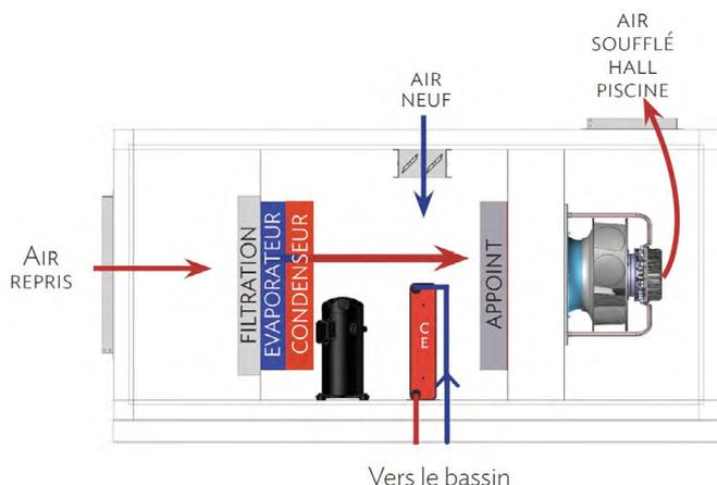
Lorsque la piscine est occupée, l'air extrait du hall, passe d'abord par l'évaporateur, où il subit une déshumidification grâce à un cycle thermodynamique.
