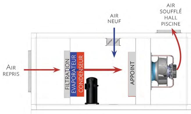
Lorsque la piscine est occupée, l'air extrait du hall, passe d'abord par l'évaporateur, où il subit une déshumidification grâce à un cycle thermodynamique.
