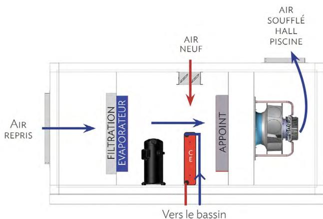
Lorsque la piscine est occupée, l'air extrait du hall, passe d'abord par l'évaporateur, où il subit une déshumidification grâce à un cycle thermodynamique. L'air neuf hygiénique (si l'option air neuf est prise), se mélange à l'air refroidi. Si l'air ambiant est à la température de consigne, alors les calories du cycle thermodynamique sont transmises à une boucle d'eau via un échangeur en titane. L'air soufflé dans le hall de la piscine est rafraîchi et déshumidifié.
