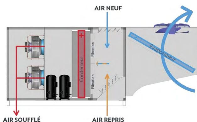
Maintien de la température ambiante en hiver par le cycle chaud (thermodynamique) avec possibilité d'ajouter un appoint ou un préchauffage (électrique/eau chaude) en option.
