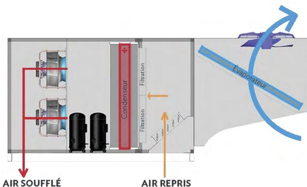
Maintien de la température ambiante en hiver par le cycle chaud (thermodynamique) avec ou sans la possibilité d'ajouter un appoint électrique ou eau chaude en option.
