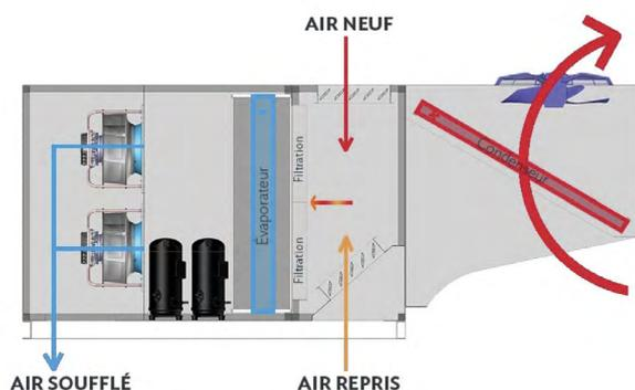
Maintien de la température ambiante en été par le cycle froid (thermodynamique).
