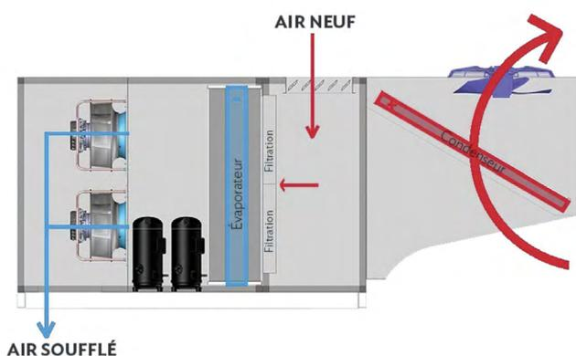
Maintien de la température ambiante en été par le cycle froid (thermodynamique). La chaleur de l'air traité prélevée par l'évaporateur est évacuée par le passage de l'air extérieur au travers du condenseur. L'évaporateur rafraîchit l'air neuf avant de le souffler dans le local traité.
