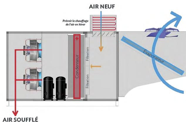
Maintien de la température ambiante en hiver par le cycle chaud (thermodynamique) avec préchauffage de l'air neuf.
