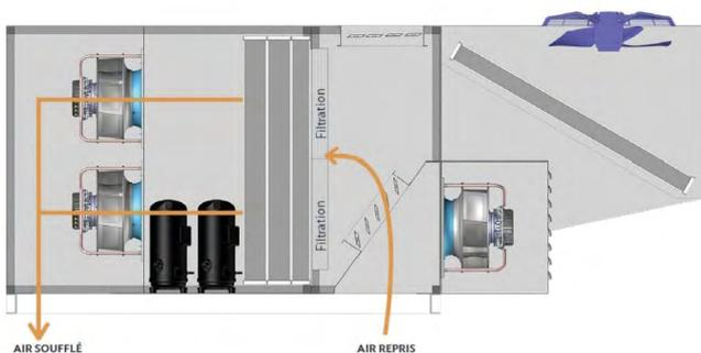
Lorsqu'il n'y a pas de besoin en air neuf hygiénique, que l'ambiance est satisfaisante, mais que la température d'air repris est supérieure à la température d'air ambiant, la machine fonctionne en recyclage et permet ainsi de faire de la déstratification (possibilité de régler la consigne d'écart entre la reprise et l'ambiance).
