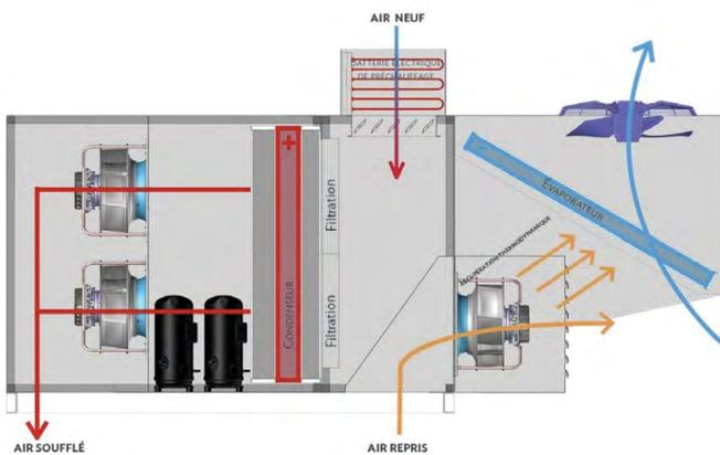
Maintien de la température ambiante en hiver par le cycle chaud (thermodynamique) avec récupération thermodynamique sur la batterie extérieure. Fonctionnement tout air neuf, préchauffage de l'air neuf par les batteries de préchauffage électrique dans un caisson extérieur (option uniquement pour les SMART E de 30 à 85) avant le passage sur le condenseur.
