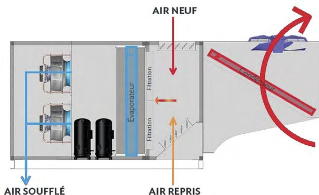
Maintien de la température ambiante en été par le cycle froid (thermodynamique) avec récupération thermodynamique sur la batterie extérieure lors des phases d'extraction (introduction d'air neuf hygiénique).
