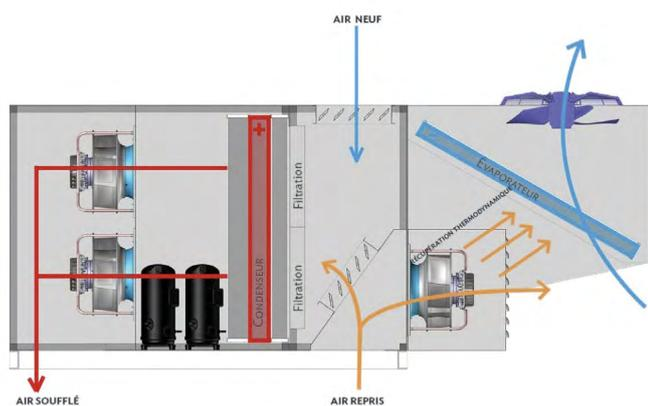
Maintien de la température ambiante en hiver par le cycle chaud (thermodynamique) avec récupération thermodynamique sur la batterie extérieure lors des phases d'extraction (introduction d'air neuf hygiénique).
