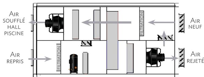
Lorsque la piscine est occupée, si la température extérieure le permet (vers 18°C extérieur), alors les compresseurs s'arrêtent (le cycle thermodynamique est à l'arrêt). Une partie de l'air recyclé, est rejeté et l'autre partie est mélangé à de l'air neuf. La déshumidification est réalisée par modulation d'air neuf.
