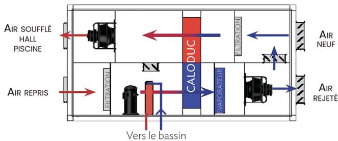
Lorsque la piscine est occupée, l'air extrait est d'abord refroidi gratuitement par un caloduc (un dispositif de transfert de chaleur). Ensuite, cet air passe par l'évaporateur, où il subit une déshumidification grâce à un cycle thermodynamique. Une partie de l'air, maintenant froid et sec, est rejeté et l'autre partie est mélangé à de l'air neuf.
